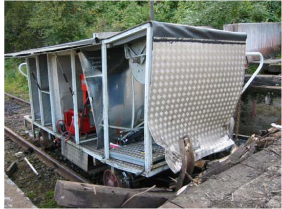
Figur 4: skadene på tralle og endebutt.
