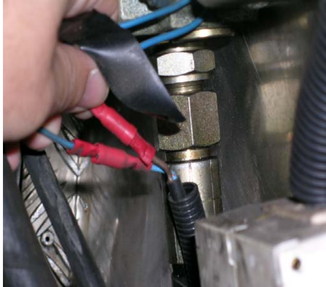
Figur 2: ledninger til retningsvenders mikrobryter.
