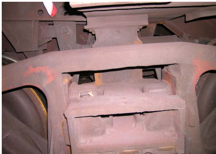
Figur 7 Ujevn kilstilling på venstre side av boggi B på vogn nr 26 i toget
