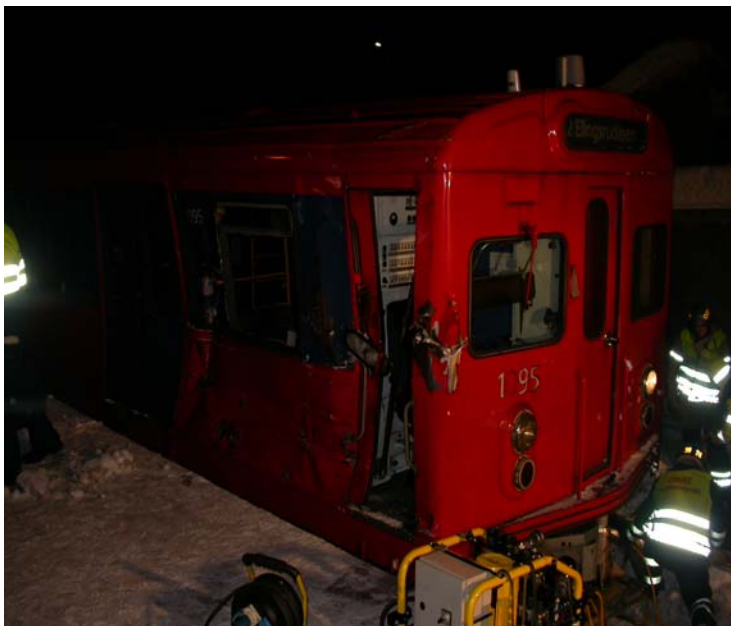
Figur 2: Skader i fronten på T-banetogets første vogn.
