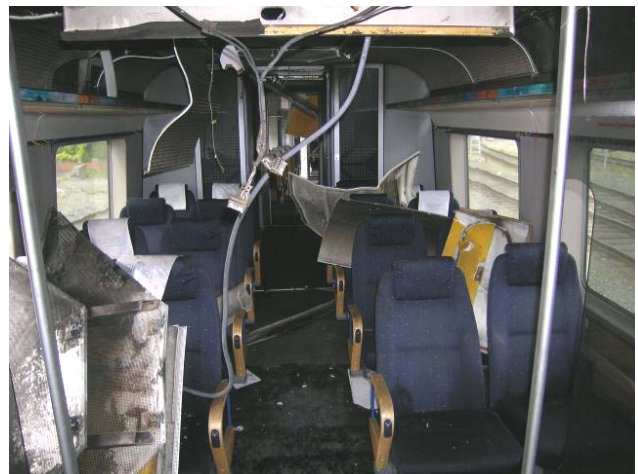
Figur 2 Røykskader og skader etter slukking i passasjeravdeling en i BM 71003.
