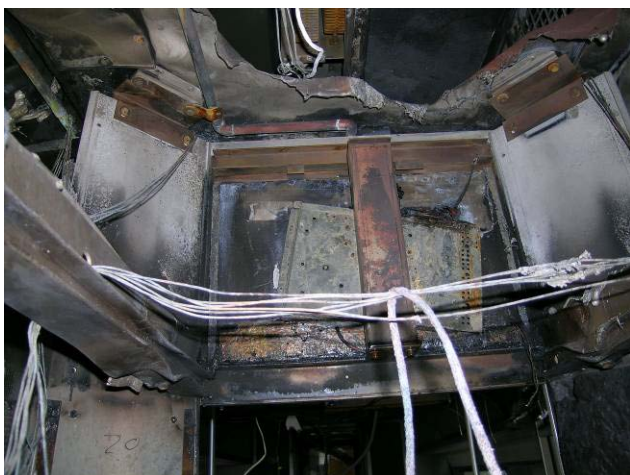
Figur 5: Bakveggen av en monitor etter brannen. I toppen av bilde sees at skilleveggen mot varmeelementene er smeltet.
