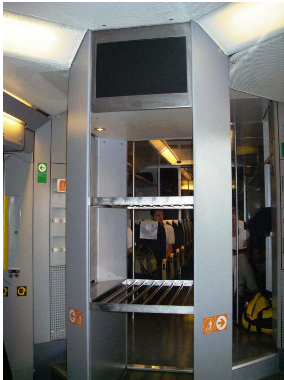
Figur 3: Bagasjesøyle med monitor i togets vestibyle.
