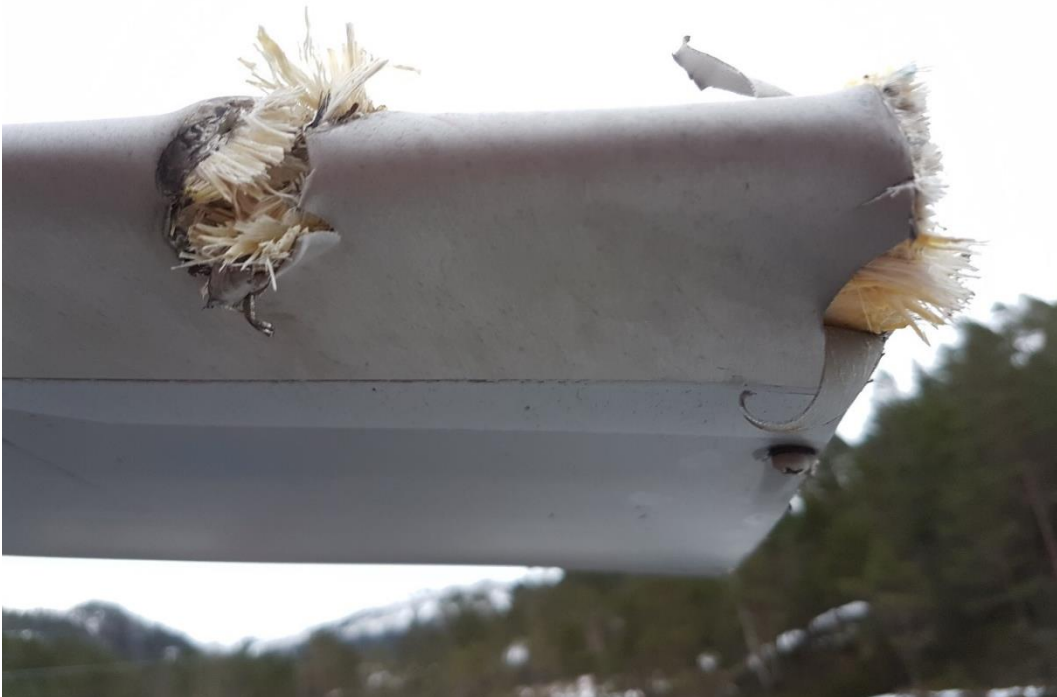
Figur 3: Alle tre hovedrotorblader ble skadet. Bildet viser skadene på det av de tre rotorbladene som var mest skadet. Skaden til venstre er trolig et resultat av berøring med kjettingen som ble kuttet av. Foto: Nord Helikopter AS
