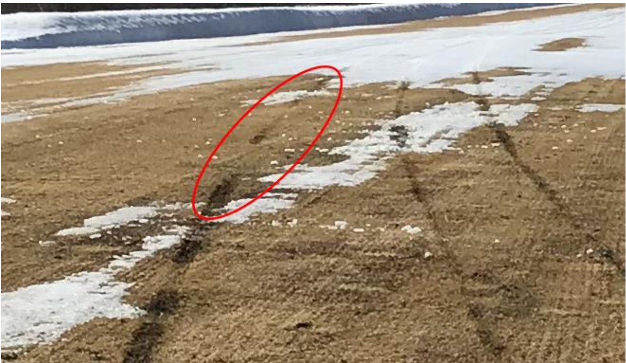
Figur 2: Hjulsporene fra LN-RAB. Partiet med svakere avtrykk fra høyre hovedhjul er markert med rødt. Foto: Privat
