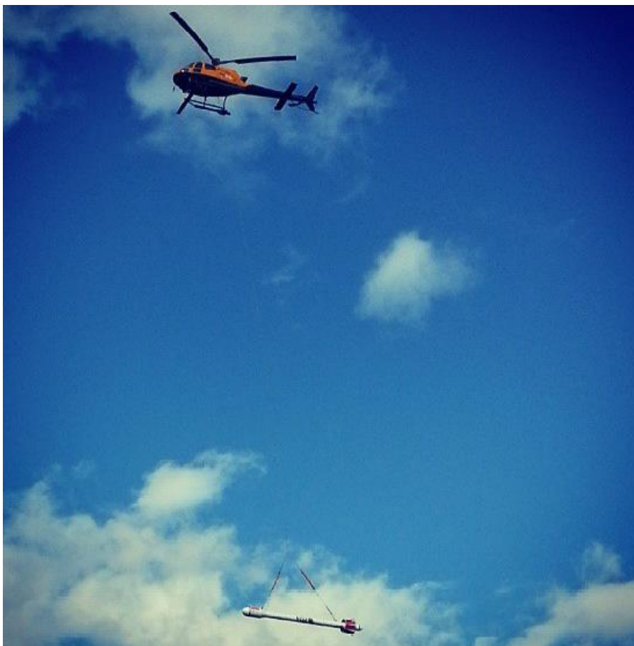
Figur 1: Helikopter med underhengende sonde. Foto: NGU
